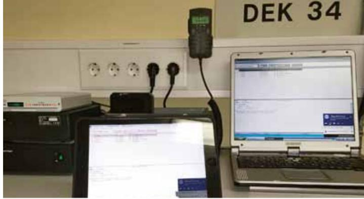
Mit diesem Kurwellenfunktgerät des Typs Codan NGT SRx in Verbindung mit einem besonderen Verschlüsselungsmodem und einem Laptop hält der Landesverband Bremen eine speziell gesicherte krisengeschützte Funkverbindung zu den anderen Landesverbänden und dem Generalsekretariat des DRK – und sogar gegebenenfalls auch zu Rotkreuzmissionen überall auf der Welt.
